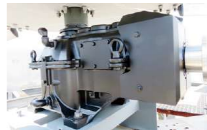
ベベルギア駆動 (B.G) 電動機の回転を、中間軸を介して減速機に伝え、翼車を回転させます。
